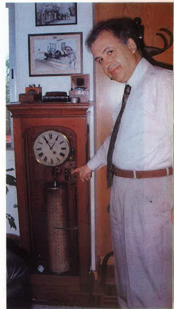
Ο κ. Μάρκαρης μάς δείχνει το μηχανήμα από το οποίο παρακολουθείτο η στάθμη του νερού μέσα στο ντεπόζιτο του υδατόπυργου.
